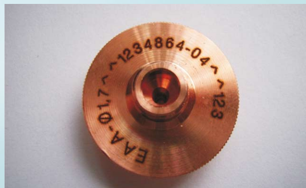
Alphanumerische Kreisbeschriftung auf Kupfer
